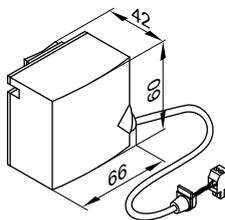
Wird mit einem Spannband befestigt.
