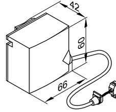
Wird mit einem Spannband befestigt.
