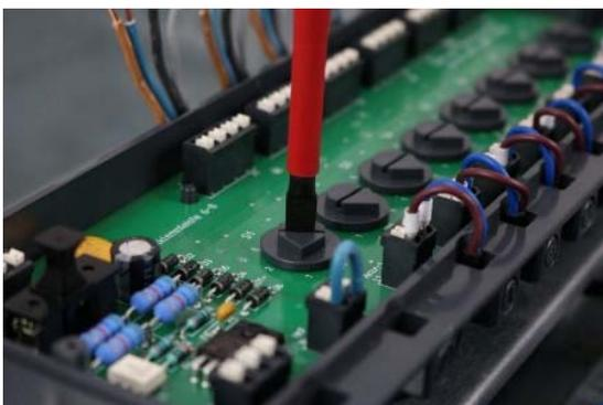
Über den Drehschalter werden die Stellantriebe manuell dem Raumthermostaten „Sensor 1...6“ bzw. „Sensor 1...8“ zugeordnet. Den eingestellten „Raum“ erkennt man an der Stellung der Spitze des Schalters. „OFF“ schließt den Stellantrieb (außer Betrieb)
