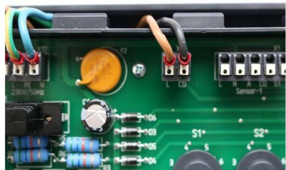
Die Klemme X26 ermöglicht durch Anschluss eines potentialfreien Schließkontaktes an der Wärmepumpe / Kältequelle die Aktivierung der CO (change over) - Funktion an den angeschlossenen Raumthermostaten. Hierdurch erfolgt eine zentrale Umschaltung der Raumthermostate auf Kühlung. Ohne Raumthermostate mit dieser Funktion ist die Kühlfunktion nicht nutzbar.
