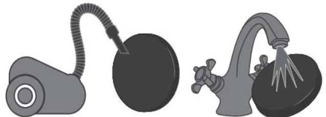
Die Filter müssen regelmäßig (alle 3 Monate) von Schmutz gereinigt werden. Nach dem Ablauf des eingestellten Filterwechselintervalls (90 Tage) leuchtet die Anzeige „Filter“.
