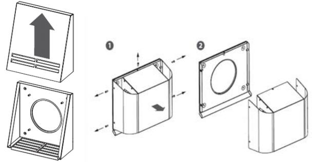
9. Setzen Sie die zentrale Lüftungseinheit wieder in das Lüftungsrohr ein. Achten Sie dabei darauf, dass der Pfeil nach oben zeigt.
