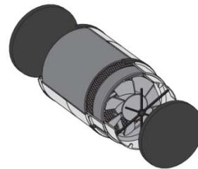
6. Die Filter waschen und trocken lassen. Die Reinigung mit einem Staubsauger ist zulässig.
