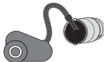
Auch bei regelmäßiger Wartung am Filter können Staubpartikel in den Wärmetauscher gelangen. Der Wärmetauscher bedarf regelmäßiger Reinigung zur Erhaltung der hohen Effizienz der Wärmerückgewinnung.
