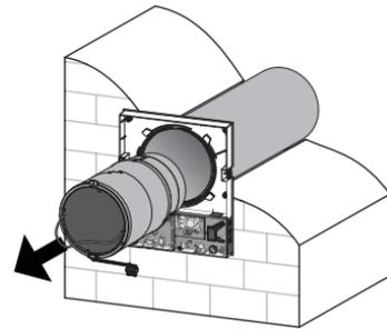
5. Entnehmen Sie die Filter aus der zentralen Lüftungseinheit.
