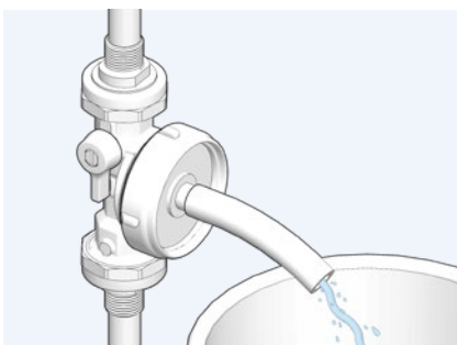
Bild 26: Entlüften mit dem VORTEX Entlüftungsflansch EF 150
