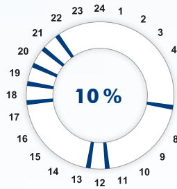
Bild 17: Die Kosten für die Bereitstellungsenergie verringern sich auf etwa 10 %, wenn eine Zirkulationspumpe mit Selbstlernmodul eingesetzt wird. Da sich das Selbstlernmodul ständig optimiert, werden minimale Pumpenlaufzeiten erreicht.
