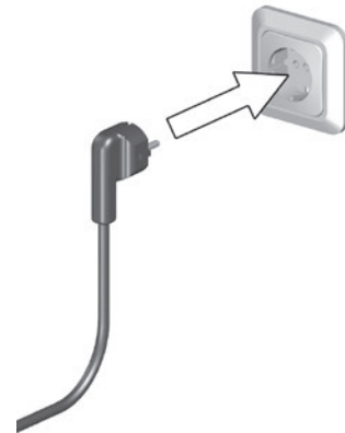
Abb. 4.14: Spannungsversorgung über 230V-Netz
