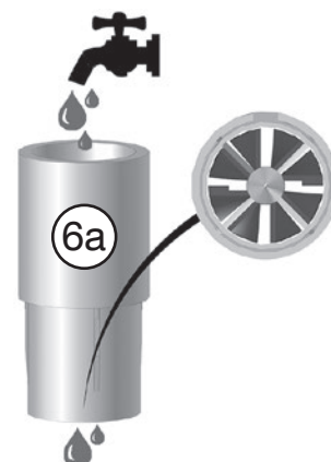
Abb. 5.18: Messturbine unter fließendem Wasser reinigen
