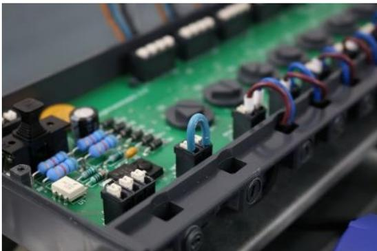
Die Klemme HKF ermöglicht durch Anschluss eines externen Temperatur- oder Taupunktsensors als Öffner-Kontakt das Abschalten und damit Schließen der Stellantriebe als Schutzfunktion gegen Überhitzung oder Tauwasserbildung. Bei Nichtbelegung der Klemme ist hier eine Brücke zu setzen. (s. Abschnitt 9.1 Schaltplan)
