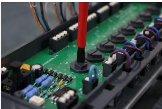
Über den Drehschalter werden die Stellantriebe manuell dem Raumthermostaten „Sensor 1...6“ bzw. „Sensor 1...8“ zugeordnet. Den eingestellten „Raum“ erkennt man an der Stellung der Spitze des Schalters.
