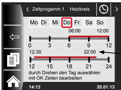
Es wird das aktuelle Schaltzeitenprogramm angezeigt.
