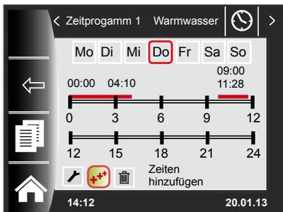
Das zu ändernde Schaltzeitenprogramm aufrufen, den gewünschten Tag auswählen und durch Drücken des Drehtasters in den Bearbeitungsmodus schalten (Schlüsselsymbol erscheint), durch Drehen des Drehtasters auf das Symbol
