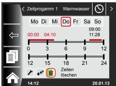
Schaltzeitenprogramm aufrufen und gewünschten Tag auswählen dann durch Drücken des Drehtasters in den Bearbeitungsmodus schalten (Schlüsselsymbol erscheint). Durch Drehen des Drehtasters auf das Symbol
