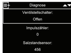
6. Stellen Sie sicher, dass hier **Offen** angezeigt wird, wenn sich der Schalterstößel unten befindet (in einer der Aussparungen in der Nocke des Ventilmotors). Wenn sich die Ventiloncke dreht (z. B. nach dem unten beschriebenen Schritt 10), befindet sich der Schalterstößel oben und hier sollte **Geschlossen** angezeigt werden.
