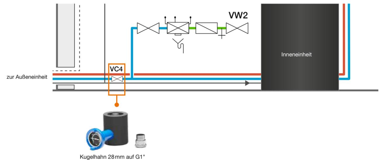
Die Heizungsanlage muss beim Befüllen **und** bei der Inbetriebnahme sorgfältig entlüftet werden. Weitere Entlüftungsventile innerhalb der Anlage sind ebenfalls zu nutzen (z. B. Heizkörper). Zusätzlich muss das Entlüftungsprogramm der Inneneinheit im Funktionstestmenü aktiviert werden.
