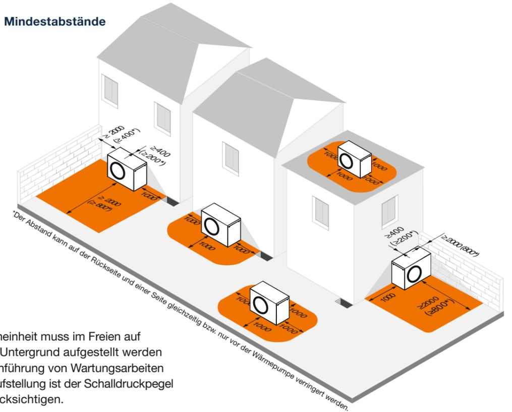
Die Wärmepumpen-Außeneinheit muss im Freien auf einem ebenen und festen Untergrund aufgestellt werden und jederzeit für die Durchführung von Wartungsarbeiten zugänglich sein. Bei der Aufstellung ist der Schalldruckpegel der Wärmepumpe zu berücksichtigen.
