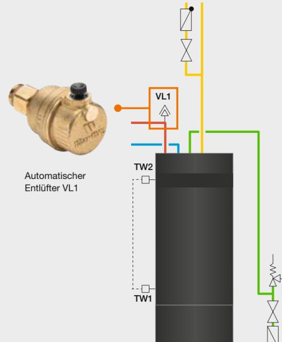
Mit dem manuellen Entlüfterventil der Außeneinheit sollte die Luft im Wärmetauscher bei der Inbetriebnahme entlüftet werden (zusätzlich zu V1).
