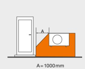
Die Wärmepumpen-Außeneinheit WLW MB AR enthält das Kältemittel R290, das eine höhere Dichte als Luft hat. Im Falle eines Lecks könnte sich das Kältemittel in Bodennähe ansammeln. Es muss daher verhindert werden, dass sich das Kältemittel in Nischen, Abflüssen, Spalten sonstigen Senken, Mulden oder Öffnungen ins Gebäude sammelt.
