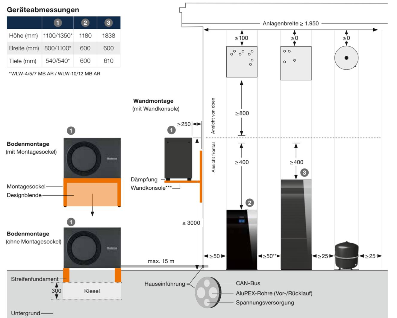
\*\* kann bei Einsatz des EWH-Speichers auf 0 mm reduziert werden. \*\* Für die Verwendung der Wandkonsole müssen die Montagefüße der WLW MB AR entfernt werden.
