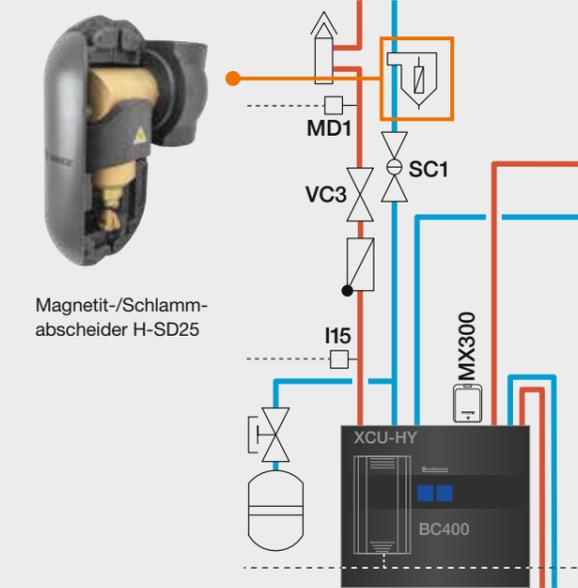
Ein Magnetit-/Schlammabscheider ist nicht erforderlich, wenn die Anlage nur eine neu installierte Fußbodenheizung umfasst.
