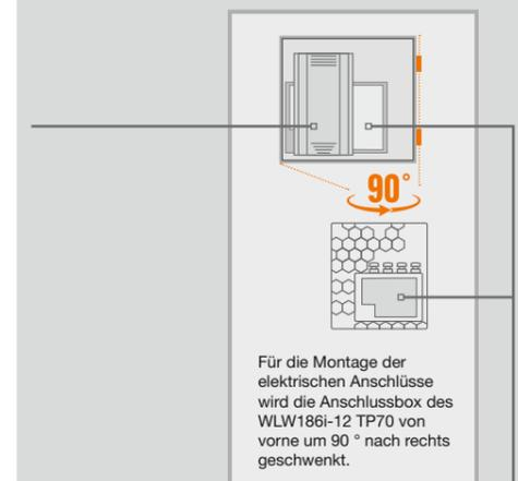
Für die Montage der elektrischen Anschlüsse wird die Anschlussbox des WLW186i-12 TP70 von vorne um 90° nach rechts geschwenkt.
